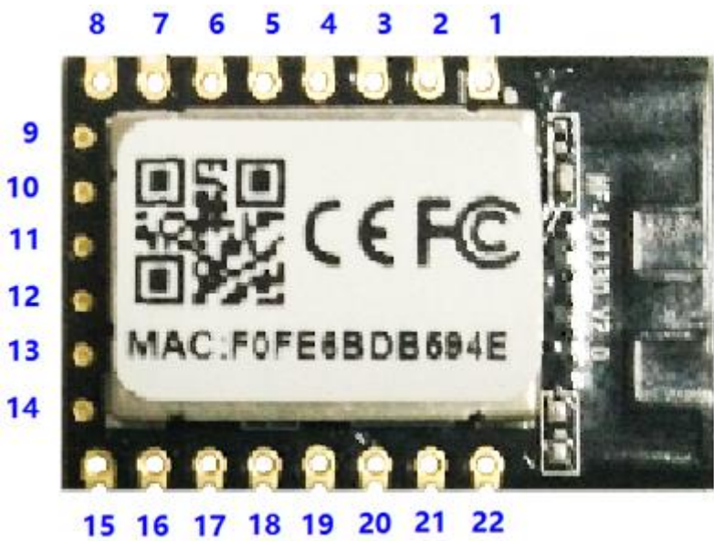
Figure 9. HF-LPT330 管脚定义
