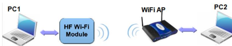
Figure 47. STA 接口连接调试
