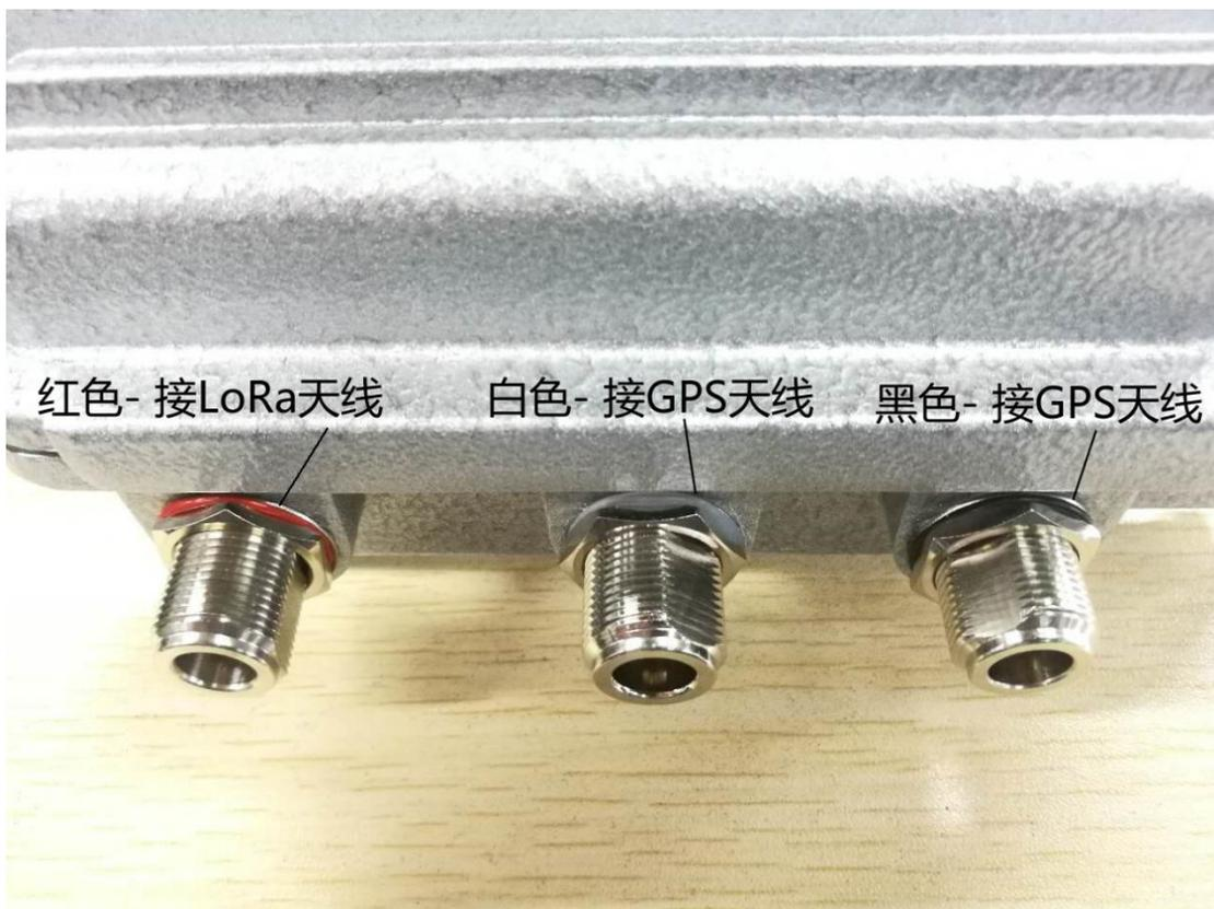
图3 网关顶部天线实物图
