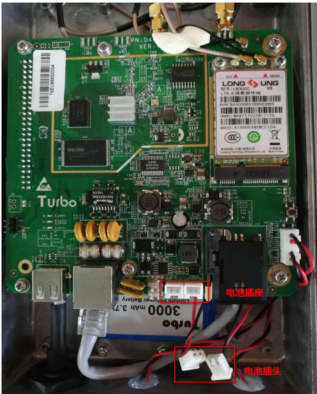
图7 备用电池连接图
