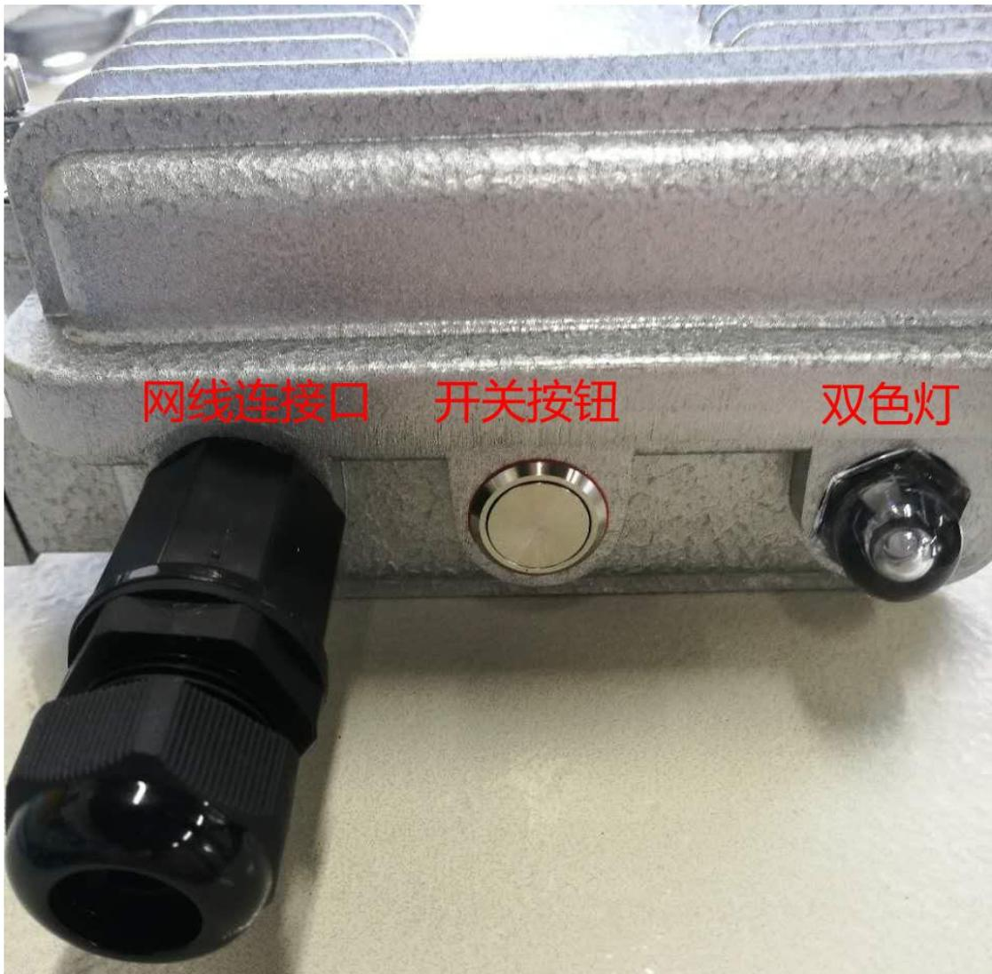
图2 网关底部实物图
