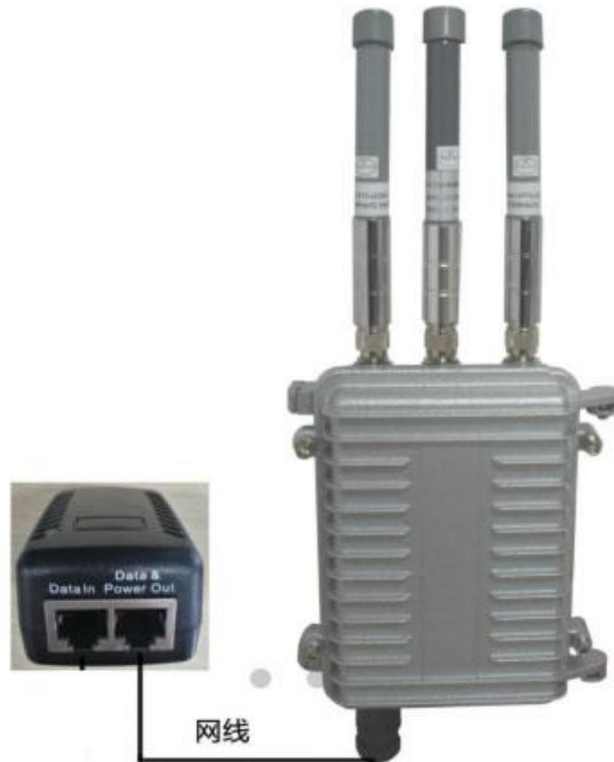
图9 TBG-510 网关无线接入网线连接图
