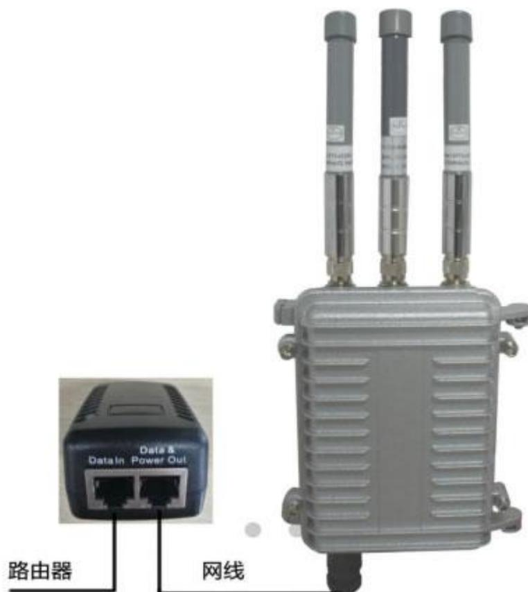
图 8 TBG-510 网关有线接入连接图
